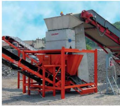
Magnetische Sortiermaschinen des CDC Rohres CDC pipe magnetic grading machines
